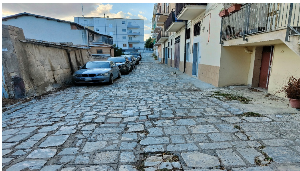
Via Europa con, sulla sinistra, deposito pericolante e pavimentazione stradale fessurata.
