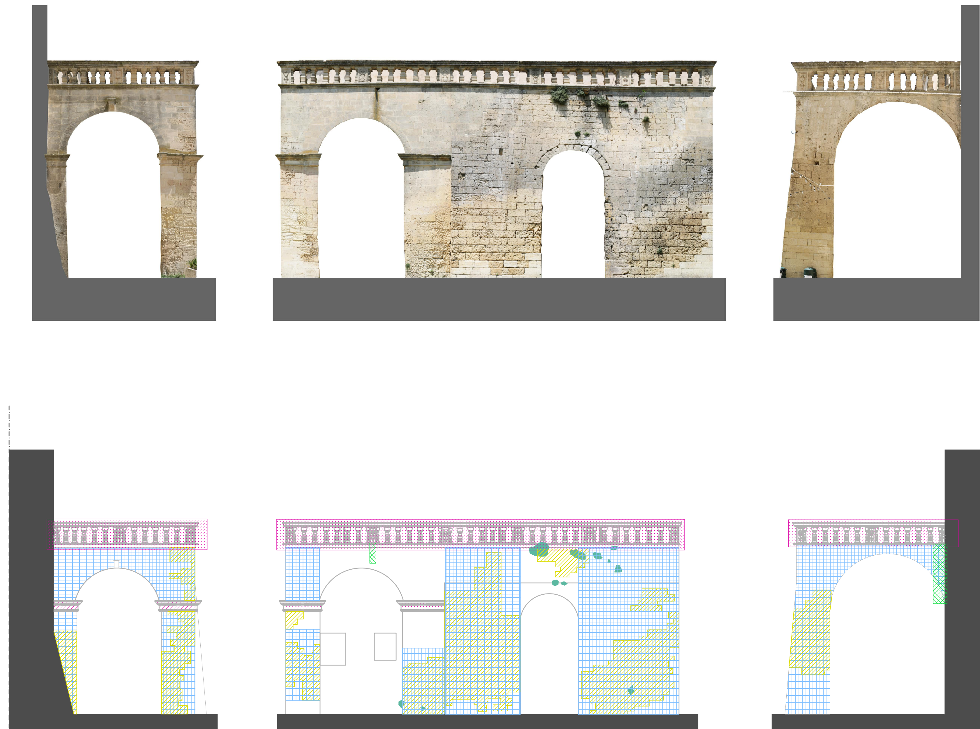
RILIEVO PATOLOGICO PROSPETTI ESTERNI LOGGIA
